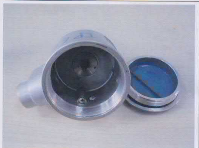
4、 IP6X 试验后受试样品照片
