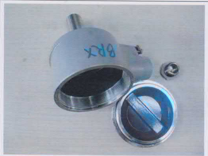
4、 IP6X 试验后受试样品照片
