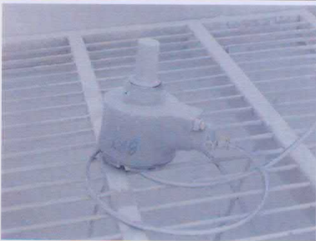
3、 IP6X 试验中受试样品照片
